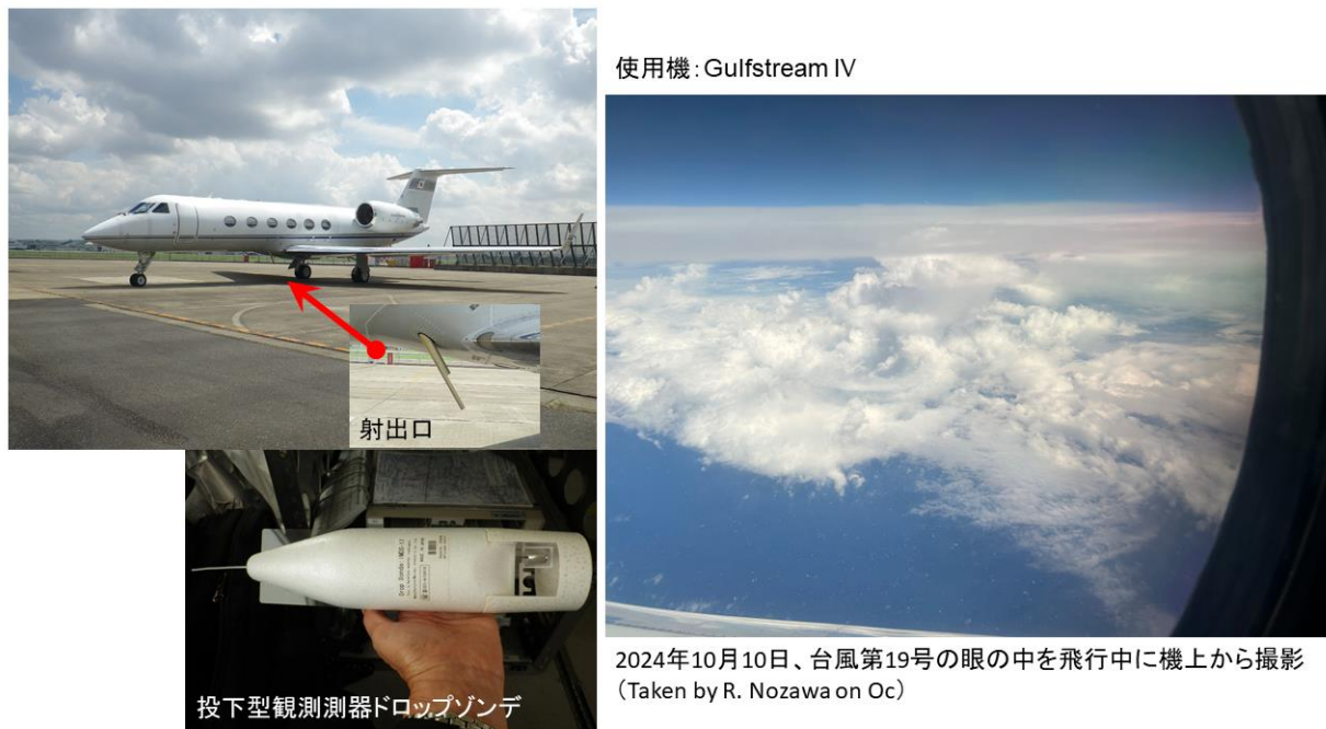
図1 左上:観測に使用した小型ジェット機(Gulfstream IV)。左下:本研究グループで開発・検証した投下型気象測器ドロップゾンデ。右:最新版のドロップゾンデを用いて2024年10月9-10日に実施した航空機観測中の台風第19号の眼の中の風景。
