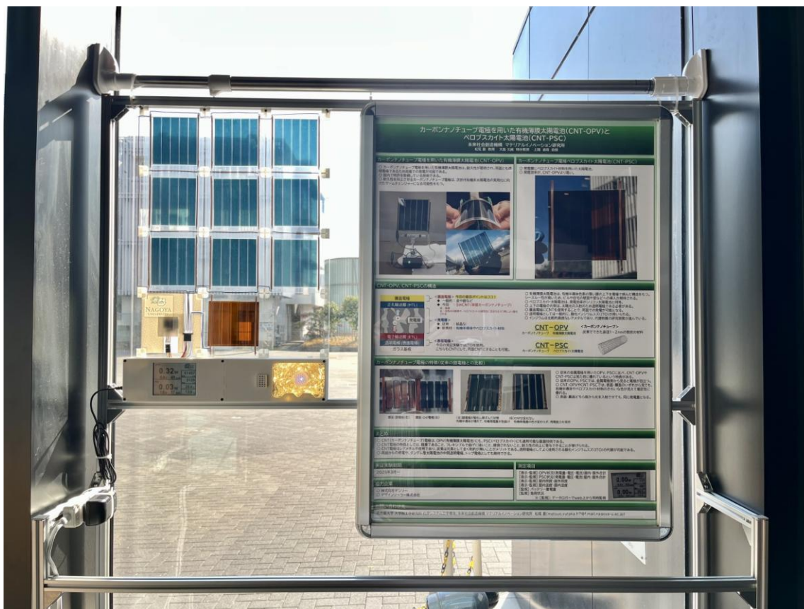
図 2. 名古屋大学のシートルエクスプレスカフェ横の窓での実証実験の様子。CNT-PSC を 1 枚、CNT-OPV を 9 枚貼り付け、発電量、光照度、温度、湿度などを記録している。
