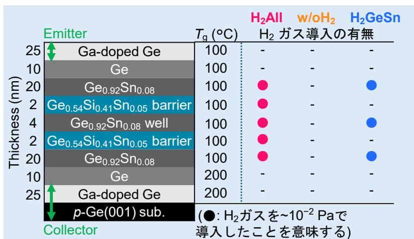
図 2: 作製した DBS の断面構造模式図。各層の膜厚、成長時の温度、および成長時の  $H_2$  ガス導入の有無をまとめている。GeSn/GeSiSn 層のすべての層に  $H_2$  を導入した試料 ( $H_2$ All)、 $H_2$  を導入しなかった試料 (w/o $H_2$ )、および GeSn 層にのみ  $H_2$  を導入した試料 ( $H_2$ GeSn) の 3 つの試料を準備した。
