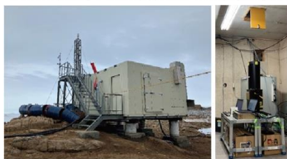
地上観測行った清浄大気観測室(左)と観測棟に設置した偏光マイクロパルスライダー(右)
