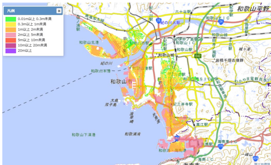
図 4. 和歌山県 最大浸水深予測結果 (「不老」 Type-II 計算)
