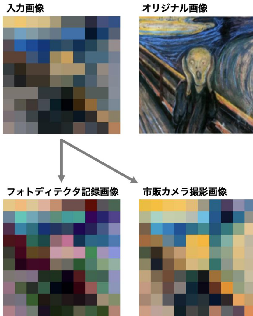
図4. フォトディテクタを用いた画像記録実験(10%ドーピング GZO を利用)。
