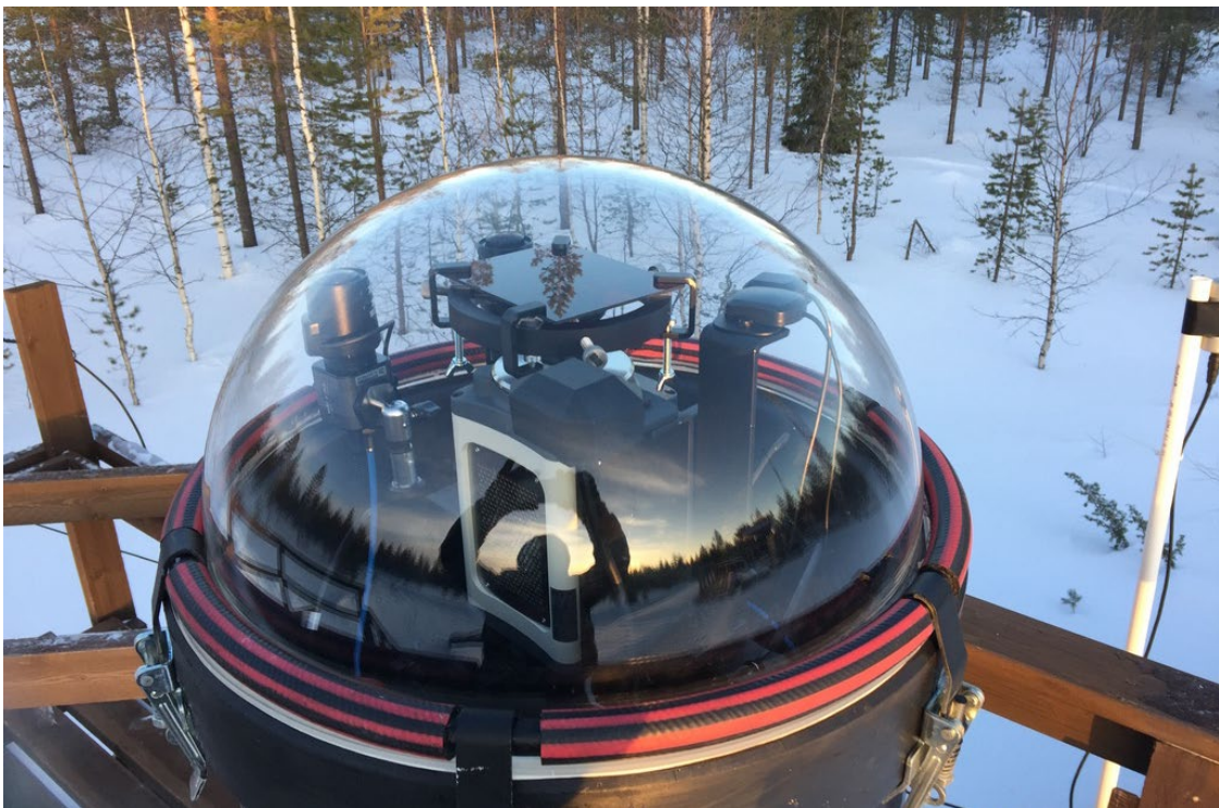
図 1: フィンランドのソダンキュラにおいて運用されている EMCCD 全天カメラ（中央部分）。 1 秒間に 100 枚のオーロラ画像を取得することができます。
